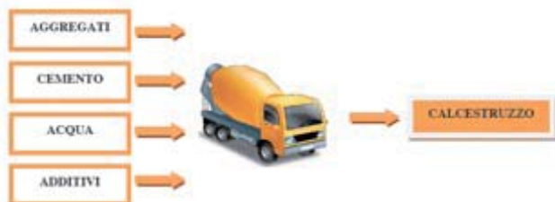
Schema produttivo del calcestruzzo a secco
