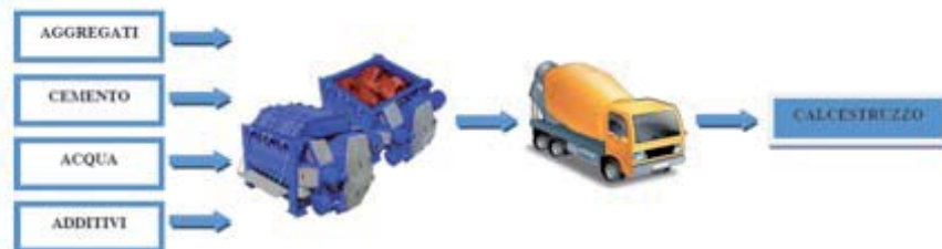
Schema produttivo del calcestruzzo con mescolatore
